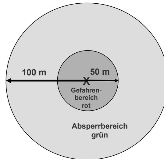
Schematische Darstellung von Gefahren- und Absperrbereich
