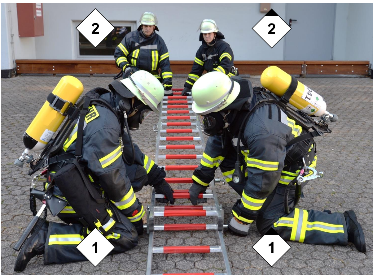
Abbildung 41: Verbinden der Multifunktionsleitern
