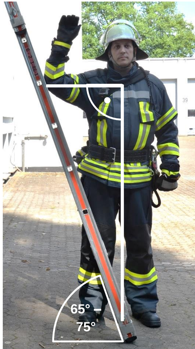
Abbildung 2: Überprüfen des Anstellwinkels
