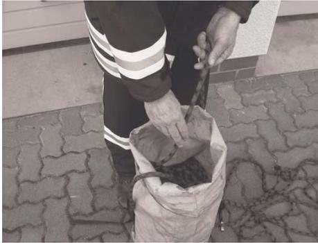
Das zuerst eingelegte Ende wird am Seilsack z. B. durch einen Mastwurf befestigt. Danach erfolgt das Einlegen des Kernmantel-Dynamikseils. Der einfache Achterknoten wird zweckmäßigerweise in das freie Seilende eingebunden und obenauf gelegt.
