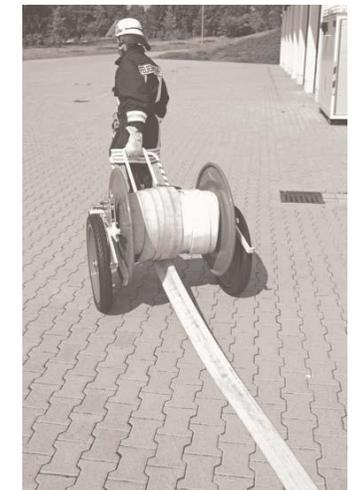
Die Schlauchhaspel wird an den Handgriffen gezogen. Der Schlauch muss von unten abrollen.
