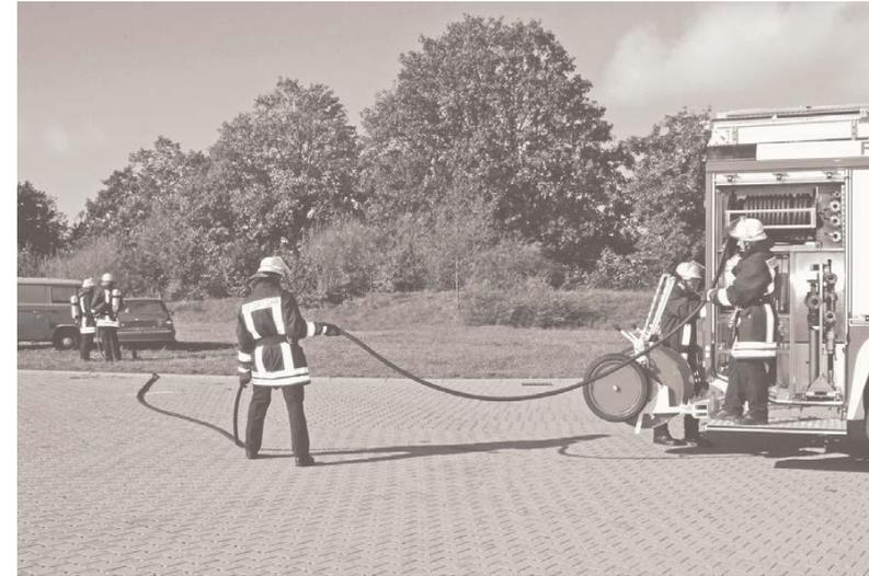
Der Truppmann nimmt das Strahlrohr aus der Halterung und geht mit dem Truppführer vor. Ein weiterer Trupp unterstützt bei Erfordernis beim Abziehen und Auslegen der Druckleitung. Auf das Kommando „Wasser marsch!“ öffnet der Maschinist das Absperrorgan an der Pumpe und gibt Wasser.
