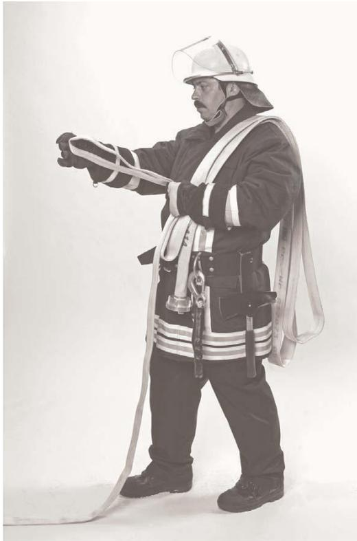
Der C-Druckschlauch wird bei der Zurücknahme in Buchten über die Schulter gelegt, wobei sich die Kupplungen vor dem Körper befinden oder er wird wie B-Druckschläuche einfach oder doppelt gerollt.
