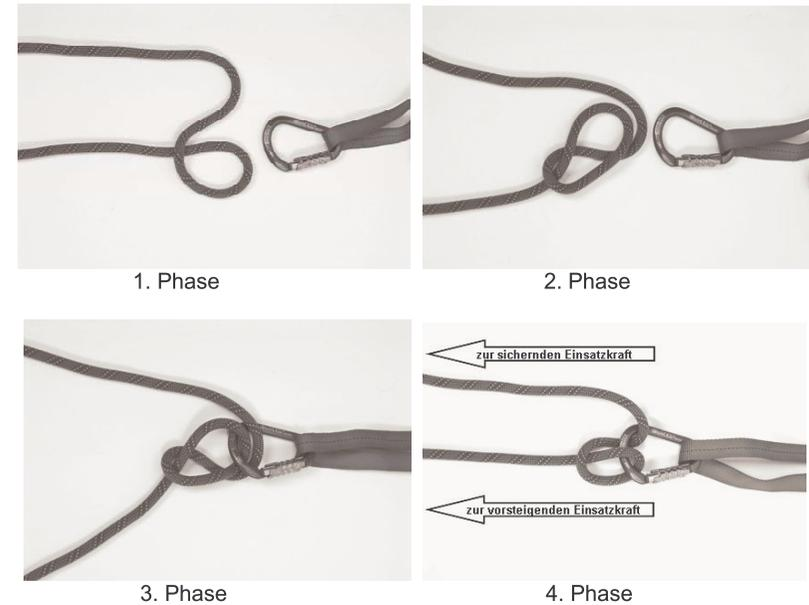
Zur Halbmastwurfsicherung mit Kernmantel-Dynamikseil darf nur ein HMS-Doppelverschlusskarabiner verwendet werden. Die Sicherung mit Kernmantel-Dynamikseil am Karabinerhaken des Feuerwehr-Haltegurtes ist nicht zulässig.
