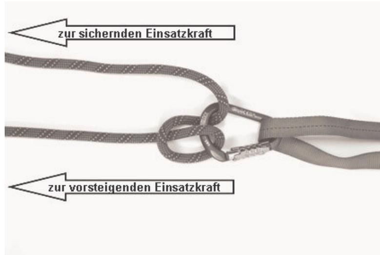
Wenn der Anschlagpunkt zu groß für eine Endlosbandschlinge ist oder verlegt werden muss, ist eine andere Methode erforderlich. Das Kernmantel-Dynamikseil wird an einem geeigneten Anschlagpunkt mittels Mastwurf angeschlagen und zusätzlich mit einem Spierenstich gesichert.
