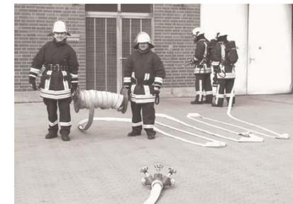
Bei der tragbaren Schlauchhaspel muss die Schlauchleitung von unten abrollen.
