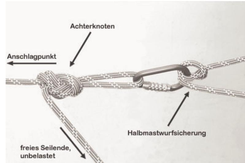
In das angeschlagene Kernmantel-Dynamikseil wird mit einem Achterknoten eine Schlaufe gebunden (vergleiche hierzu Abbildung 1 im Kapitel 17.1.1). In diese Schlaufe wird ein HMS-Doppelverschlusskarabiner eingeklinkt, in dem der Halbmastwurf eingelegt wird.
