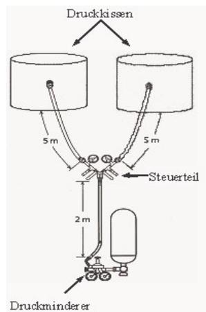
Das Hebekissensystem besteht aus Druckkissen mit Füllschlauch, einer Druckluftflasche mit Druckminderer, einem Luftschlauch zur Verbindung von Druckminderer und Steuerteil und dem Steuerteil mit Kupplungen zum Anschluss für Luftschlauch und Füllschläuche. Vom Steuerteil können ein oder zwei Druckkissen betrieben werden.
