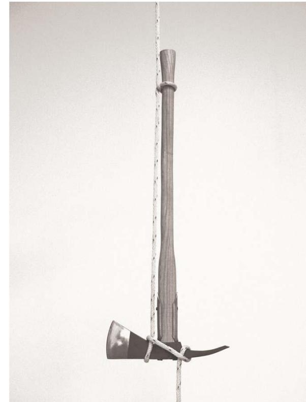
Verwendet werden Mastwurf und Halbschlag. Anstelle des Mastwurfs kann auch der doppelte Ankerstich angewendet werden.
