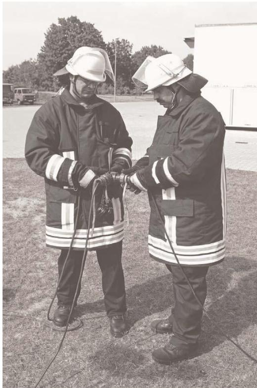
Die elektrische Leitung wird vollständig von dem Leitungsroller abgerollt, um unzulässige Erwärmung zu vermeiden. Wird nicht die gesamte Länge der Leitung benötigt, so ist der verbleibende Rest an geeigneter Stelle in Buchten zu verlegen. Stolperfallen sind zu vermeiden.
