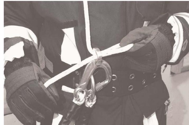
Die am Anschlagpunkt befestigte Feuerwehreine wird in eine Schlaufe gelegt und durch die Multifunktionsöse des Karabinerhakens geführt. Die Schlaufe wird in den Karabinerhaken eingeklinkt.
