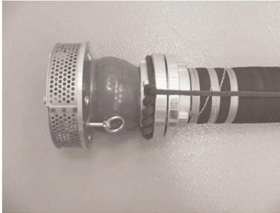
Sofern eine Halteleine verwendet wird, ist diese am Saugkorb vor dem Anbringen des Saugschutzkorbes mittels Zimmermannsschlag oder Mastwurf und Spierenstich zu befestigen. Anschließend wird sie an jedem Saugschlauch mittels Halbschlag befestigt. Es ist darauf zu achten, dass die Halteleine angemessen fest verlegt wird. Sie wird an einem geeigneten Festpunkt befestigt. Das Anbringen der Halteleine ist insbesondere bei fließenden Gewässern und in Schächten zweckmäßig.
