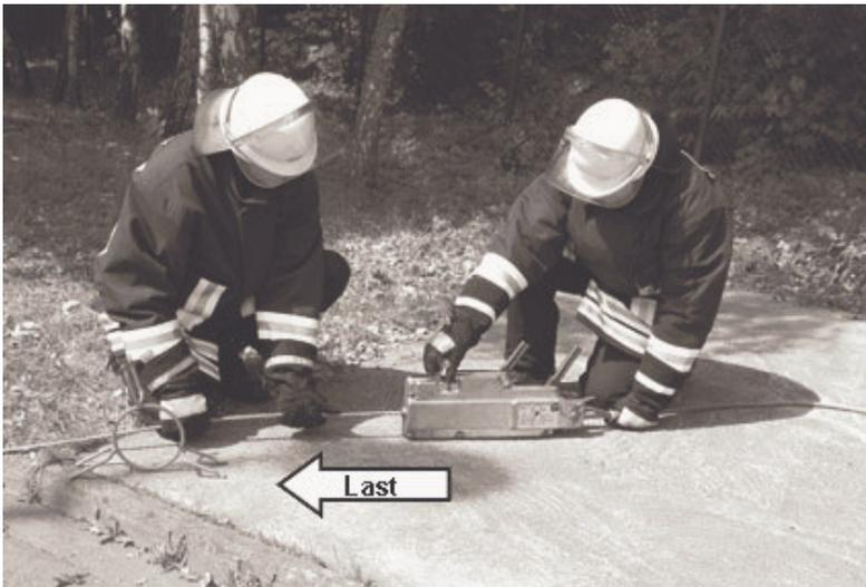
Am Mehrzweckzug befinden sich ein Vorschub- und ein Rückzughebel sowie ein Schaltgriff zum Arretieren und Lösen des Zugseils. Im Vorschubhebel ist eine Über-
