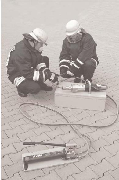
Schneidgerät mit motorgetriebener Hydraulikpumpe
