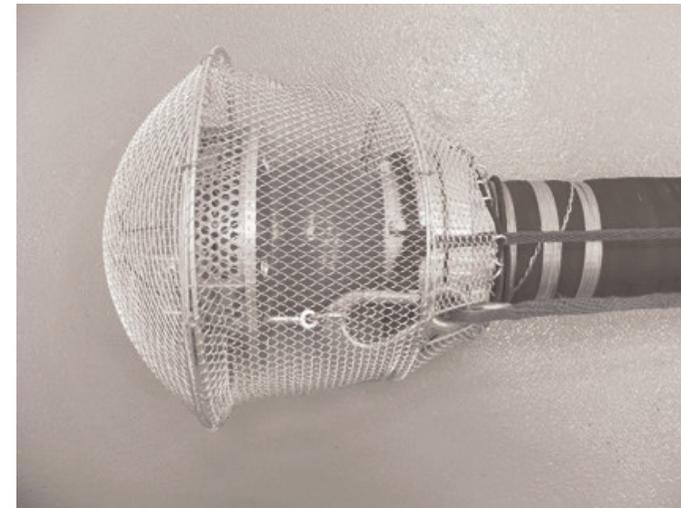
Beim Anbringen eines Saugschutzkorbes darf die Ventilleine nicht eingeklemmt werden.
