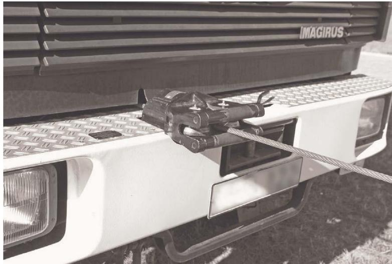
Die Zugkraft ist durch geeignete Verwendung der Zugeinrichtung so zu begrenzen, dass ein Wegrutschen des ziehenden Fahrzeugs ausgeschlossen ist.
