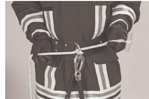
Der Halbmastwurf dient bei Verwendung einer Feuerwehrleine als Bremsknoten beim Selbstretten und zum Halten.
